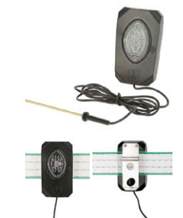
SIGNAL LIGHT Permanente signaallamp op de schrikdraad Knippert naar het ritme (impuls) van de schrikdraadapparaat. Onder 3000 Volt werkt deze lamp niet meer voor de onveiligheid van de schrikdraad aan te tonen.
