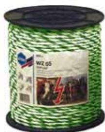
WZ 65 K Top Leit Plus Nylonkoord van 6,5 mm Ø Met 6 koperdraden van 0,30 mm Ø Kleur - wit met groen 0,03 Ω/m, trekkracht: 250 kg Spoel van 200 m Art. Nr. 13 518 € 59,50
