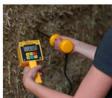
NIEUW Hygrometer voor hooi en stro Digitale vocht- en temperatuurmeter voor hooi, stro en kuilvoer. Met een 55 cm lange sonde die variaties in elektrische geleidbaarheid meet en omzet in vochtigheidspercentage.
